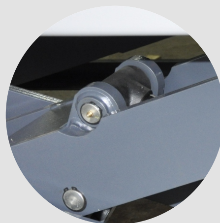
ПОДАЧА СМАЗКИ ЧЕРЕЗ БОЛТЫ- ТАВОТНИЦЫ
